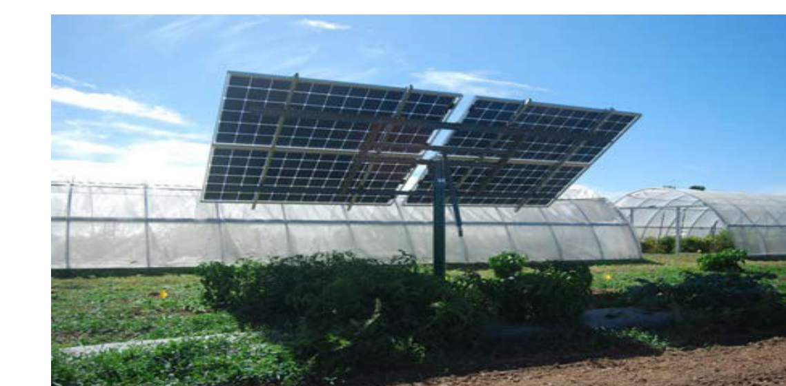
Si Monocrystalline Bifacial Module.
